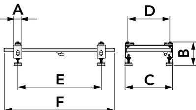
Disponibile in singola confezione comprendente: bacinella, supporti a pavimento, viti di bloccaggio, pipetta scarico condensa, antivibranti a scorrimento e piedini antivibranti regolabili.
