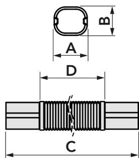
Tramite la flessione permette il passaggio di grondaie, tubi gas e ostacoli in generale
