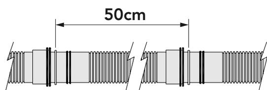
Il tubo, realizzato in coostrusione, permette una maggiore resistenza agli agenti atmosferici ed all'acqua di condensa.
