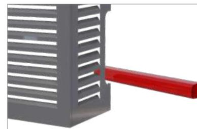
Predisposizione per passaggio canalina tubazione e cablaggi
