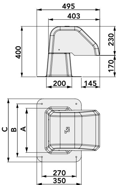
Il passaggio a tetto di Tecnosystemi viene utilizzato per proteggere i fori presenti sulle coperture realizzati per il passaggio delle tubazioni frigorifere e cablaggi che collegano l'unità esterna dall'unità interna.
